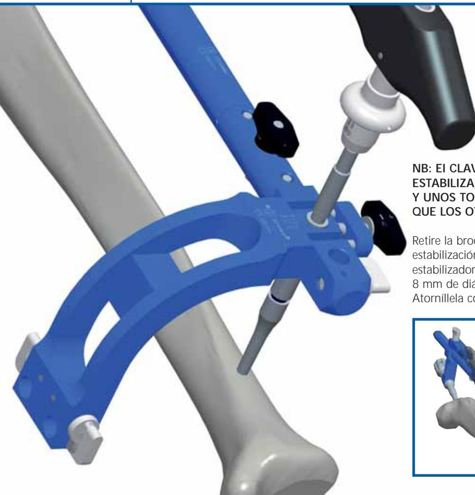
**NB: EI CLAVO DE 8 MM PRECISA UNA BARRA ESTABILIZADORA, UNA BROCA, UNA GUÍA DE BROCA Y UNOS TORNILLOS DE BLOQUEO MÁS PEQUEÑOS QUE LOS OTROS CLAVOS. VÉASE EL TEXTO.**
