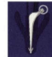
**Contacto de la superficie altamente pulida entre el vástago y el cemento.**
